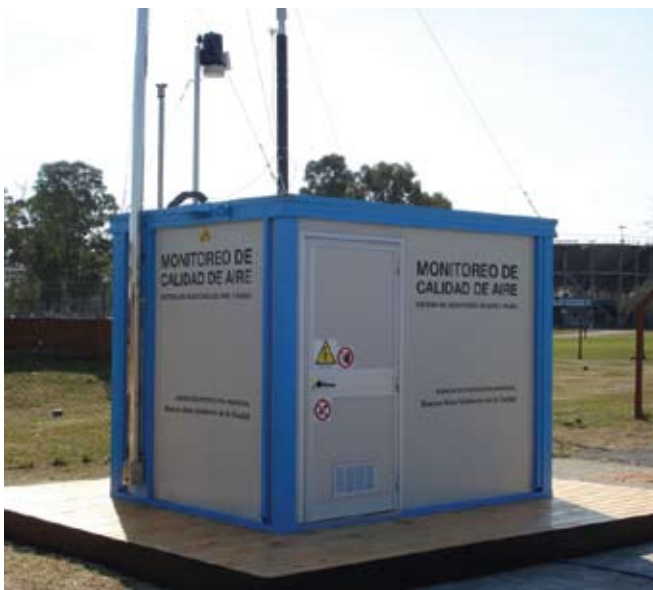
Una estación EPA es prácticamente un laboratorio de captura y análisis de muestras de contaminantes presentes en el aire. Actualmente hay una ubicada en el Barrio Catalinas Sur, que mide la influencia de Dock Sud y el Riachuelo.
