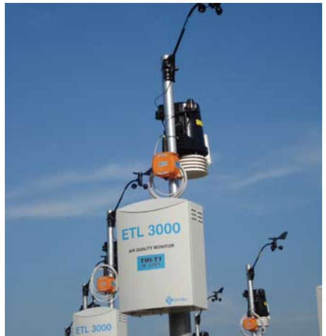
Las torres de Monitoreo Inteligente (TMI), son estaciones de alto nivel tecnológico con capacidad para medir la concentración de carbono, ozono, benceno, humedad, ruido y otros factores del medio ambiente y enviar esa información en tiempo real a una central de procesamiento de datos.
