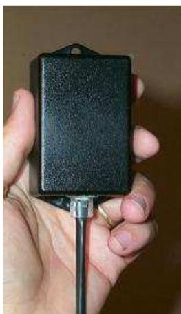
L'antenna è costituita da un piccolo box che può essere installato all'interno o all'esterno. Nel caso di installazione all'esterno è necessario prevedere una opportuna protezione per l'umidità e la pioggia, tramite l'utilizzo di una scatola in materiale plastico ed un palo in pvc. Non devono essere utilizzate parti metalliche per il fissaggio ne deve essere fissata a strutture in ferro. Il ferro ostacola la ricezione del segnale.
